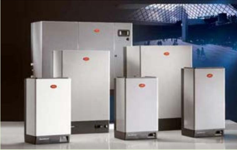
В паровых увлажнителях воздуха используется внешний источник тепла, электричество или газ. В электрических погруженные в воду электроды или трубчатые нагревательные элементы доводят воду до кипения с последующим образованием пара. Образующийся пар вводится в канал системы вентиляции или подается непосредственно в помещение через специальное отверстие. Пар полностью поглощается воздухом.
