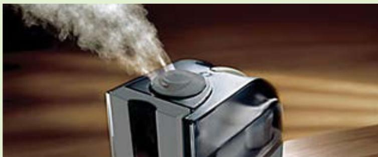
В конструкцию ультразвукового увлажнителя воздуха входит небольшая емкость с водой, на дно которой установлены пьезоэлектрические излучатели. Пьезоэлементы под воздействием приложенного переменного тока вибрируют с высокой частотой (обычно более 1 МГц).
